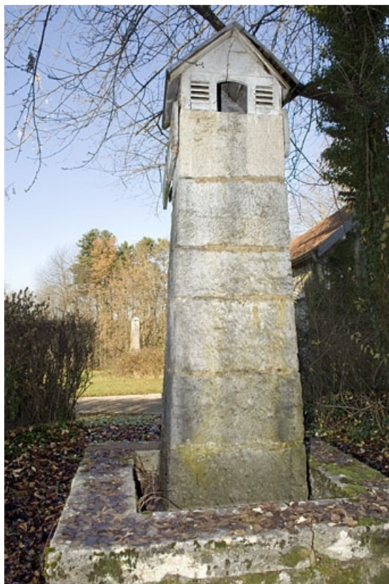
Mire nord de la lunette méridienne : pilier sud (collimateur). 25, Besançon, 34 avenue de l' Observatoire, lieudit : la Bouloie
