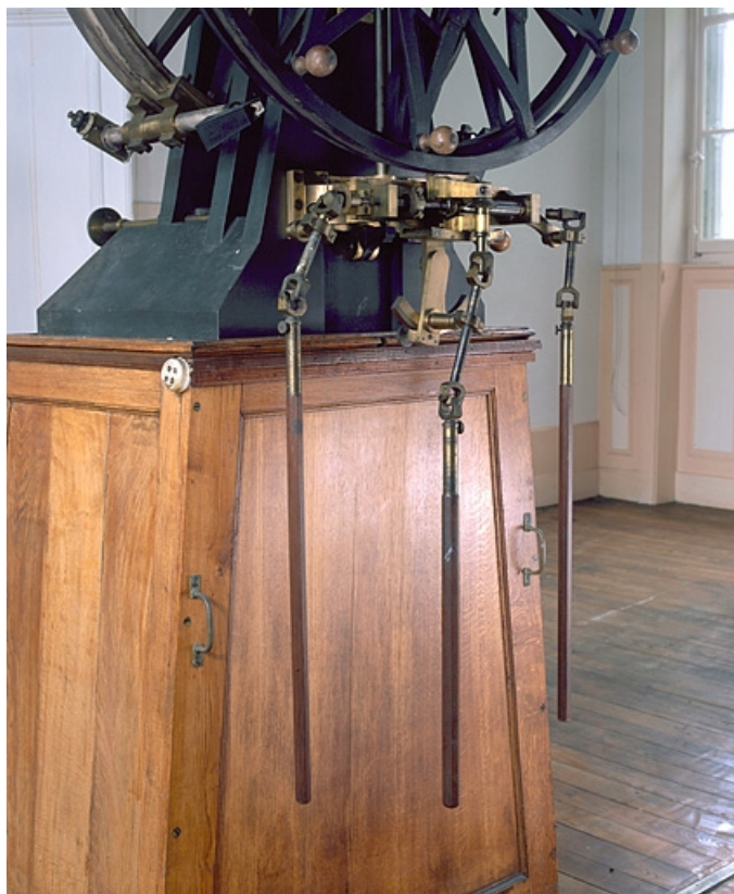
Mécanisme de blocage situé sous chaque cercle de mesure.
