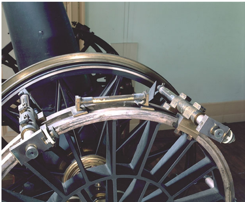
Vue de détail d'un des deux cercles avec niveau et microscopes.
