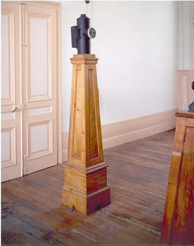
L'une des deux lanternes permettant d'éclairer les cercles gradués de la lunette.
