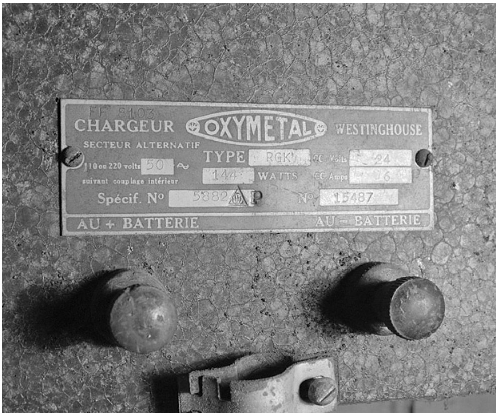
Chargeur de batterie Oxymétal Westinghouse : plaque signalétique.
