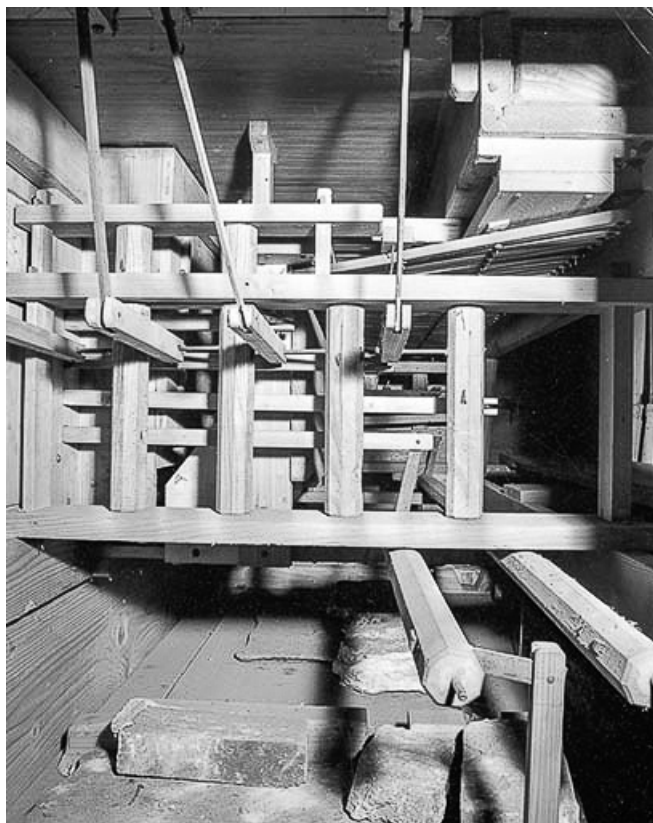
Mécanique des rouleaux de registre vue de face.
