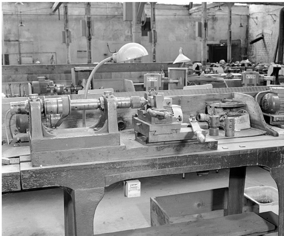
Déplacement de la troisième main vers la gauche : la mèche perce la tige (atelier principal). 25, Baume-les-Dames rue des Pipes, lieudit : Gondé
