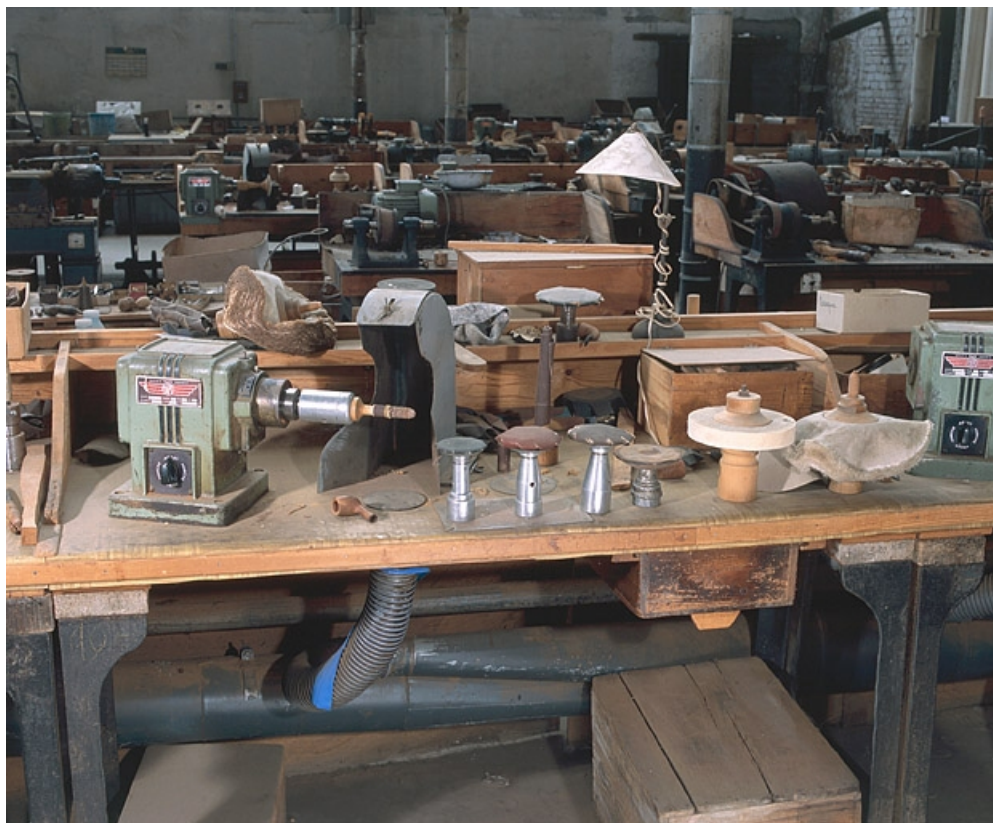
Vue d'ensemble d'un polissoir, de ses différents mandrins et de la bouche d'aspiration des poussières (atelier principal). 25, Baume-les-Dames rue des Pipes, lieudit : Gondé
