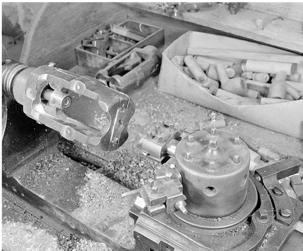
Tour (atelier de finissage). Les mâchoires et le revolver alignés, vus de trois quarts droite. 25, Baume-les-Dames rue des Pipes, lieudit : Gondé
