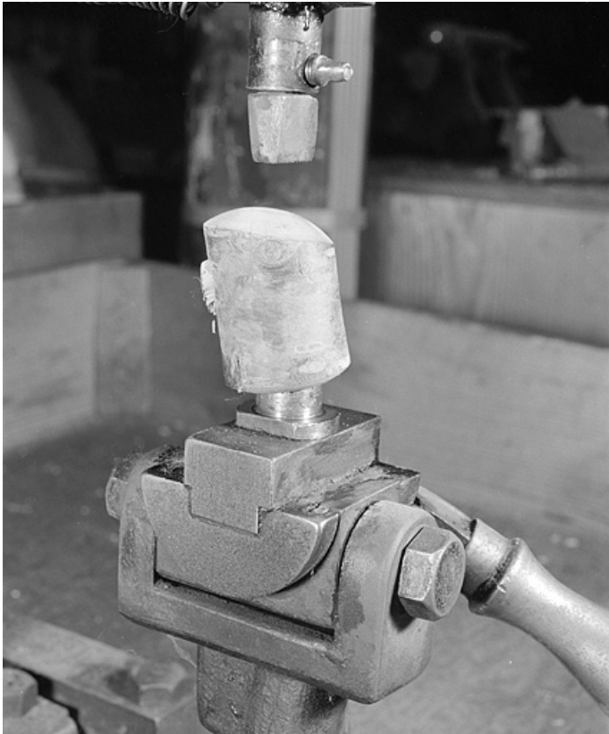
Détail du culot amovible présentant un fourneau dans l'axe de descente du poinçon.
