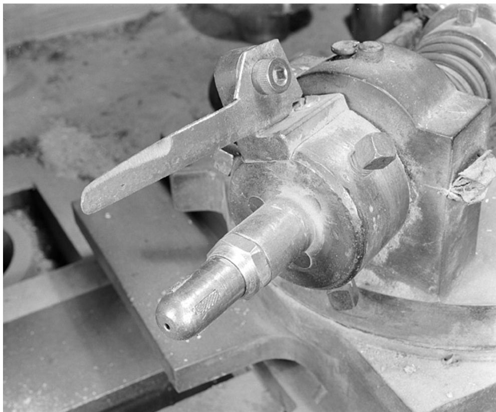
Détail du système de fixation du fourneau par l'intérieur du foyer (arrondissement de l'atelier de finissage). 25, Baume-les-Dames rue des Pipes, lieudit : Gondé
