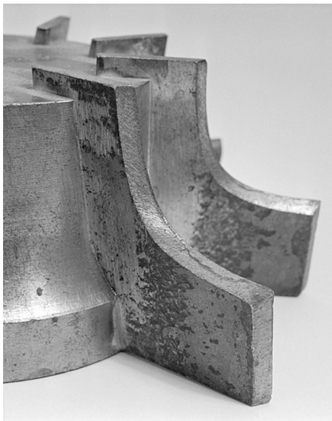
Détail d'une fraise, montrant le profil des fers.
