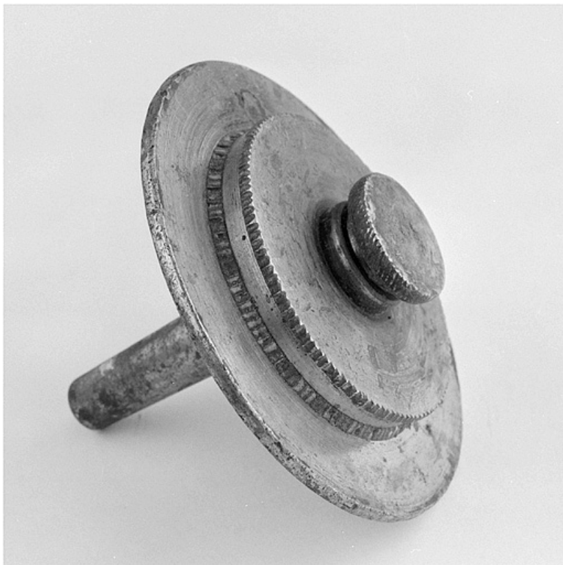
Détail d'un outil de coupe, montrant de profil les trois disques qui chanfreinent. 25, Baume-les-Dames rue des Pipes, lieudit : Gondé
