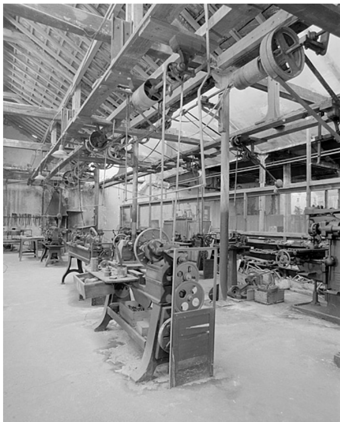
Atelier de mécanique. Distribution par courroies verticales.
