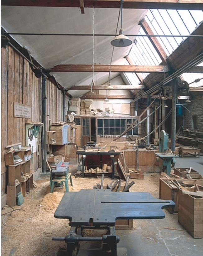
Atelier de menuiserie. Distribution par courroies obliques des machines situées au sud de l'atelier. 25, Baume-les-Dames rue des Pipes, lieudit : Gondé
