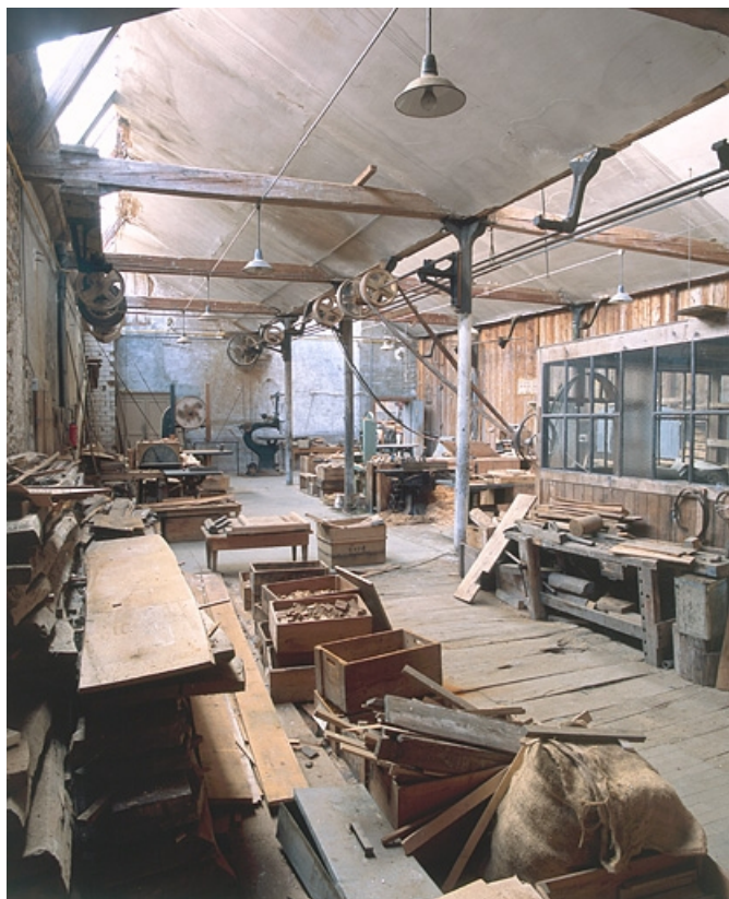
Vue d'ensemble de l'atelier de menuiserie. Axe principal à droite et axe secondaire contre le mur à gauche. 25, Baume-les-Dames rue des Pipes, lieudit : Gondé
