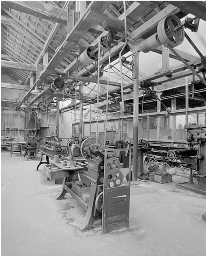
Atelier de mécanique. Distribution par courroies verticales.
