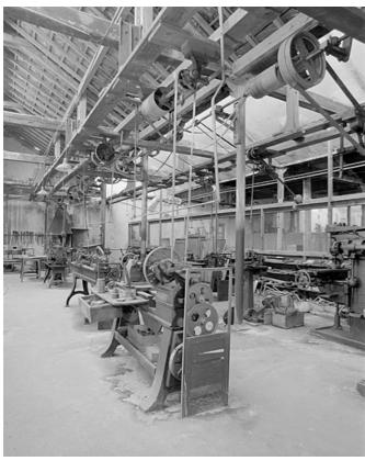
Atelier de mécanique. Distribution par courroies verticales.
