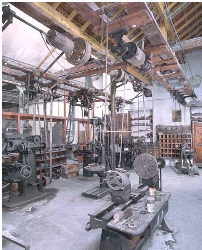
Atelier de mécanique. Détails de distribution par courroies verticales et par renvois.
