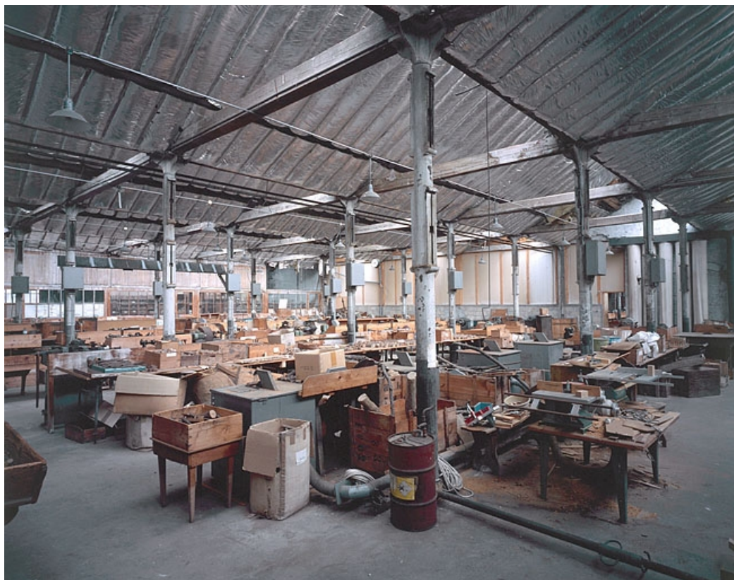
Partie ouest de l'atelier de fabrication de pipes. Les poteaux de fonte conservent la trace des consoles qui soutenaient les quatre arbres de transmission.
