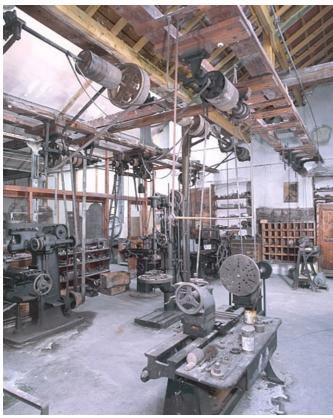
Atelier de mécanique. Détails de distribution par courroies verticales et par renvois. 25, Baume-les-Dames rue des Pipes, lieudit : Gondé
