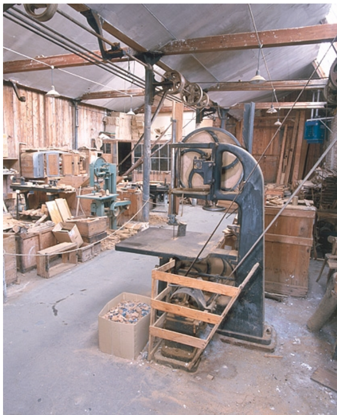
Vue de côté, avec la transmission par courroie.
