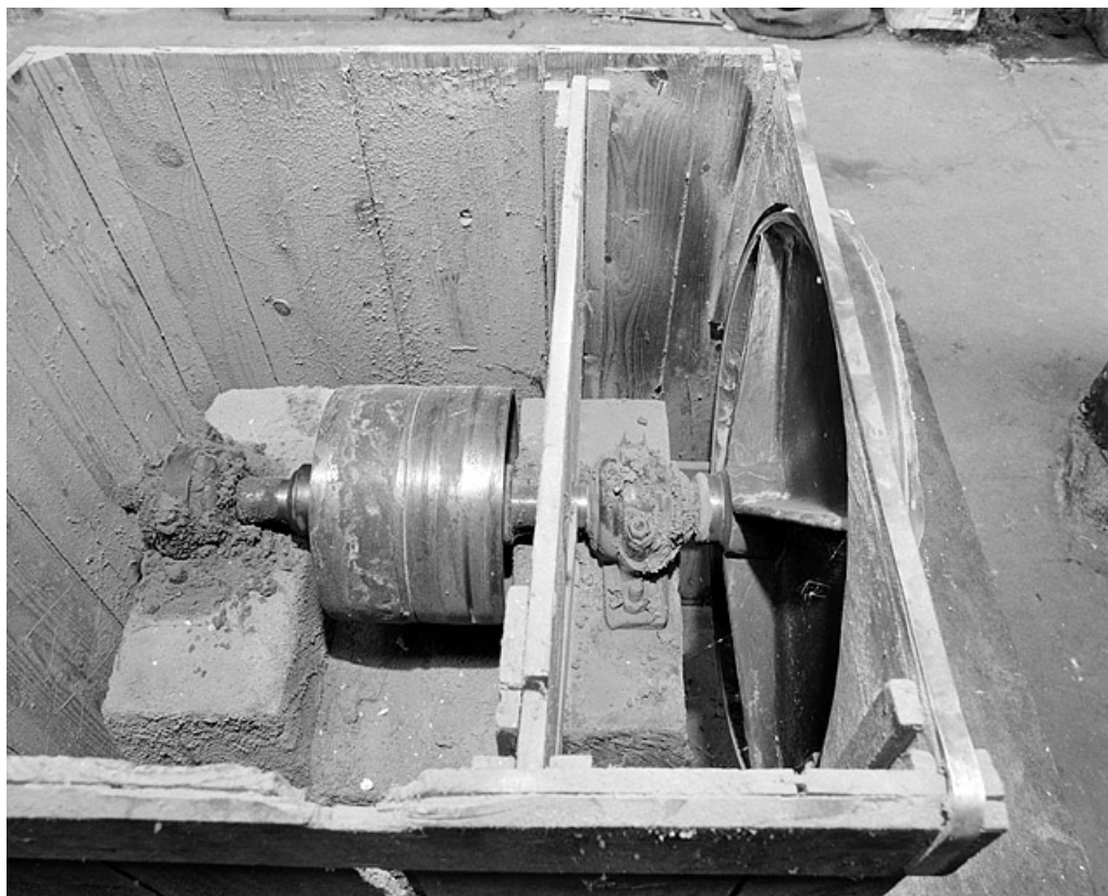
Vue plongeante sur le mécanisme d'entraînement (carcasse enlevée).
