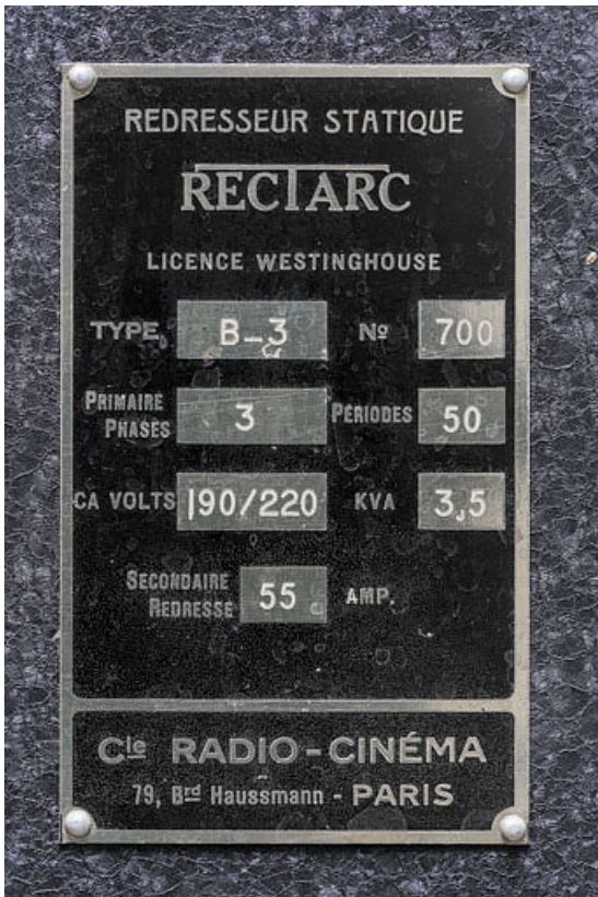
Redresseur Rectarc désaffecté : plaque de constructeur. 21, Beaune, 64 rue de Lorraine
