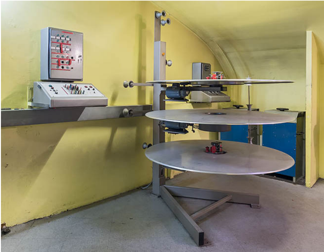
Pupitre à matrice à diodes et dérouleur à plateau Kinoton ST-270. 21, Dijon, 8 place Darcy
