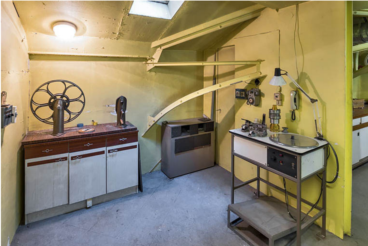
Installation de rembobinage manuel à gauche et table de bobinage Kinoton ST-272 à droite. 21, Dijon, 8 place Darcy
