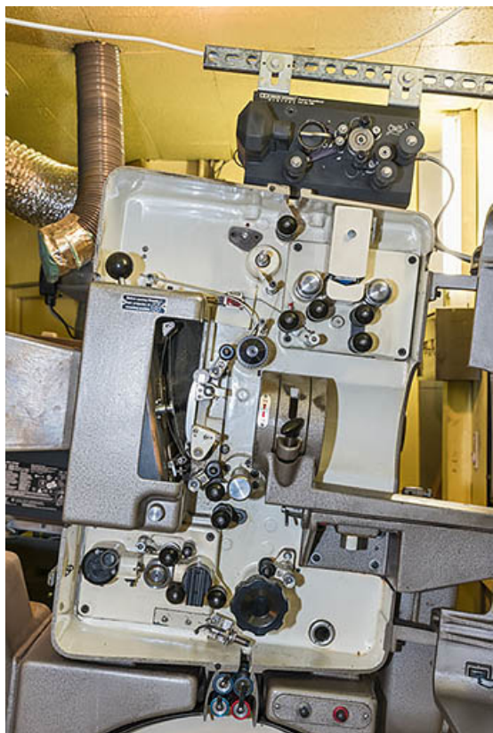
Projecteur argentique Philips DP 70 : système d'entraînement du film. 21, Dijon, 8 place Darcy
