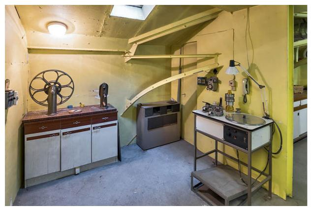
Installation de rembobinage manuel à gauche et table de bobinage Kinoton ST-272 à droite.
