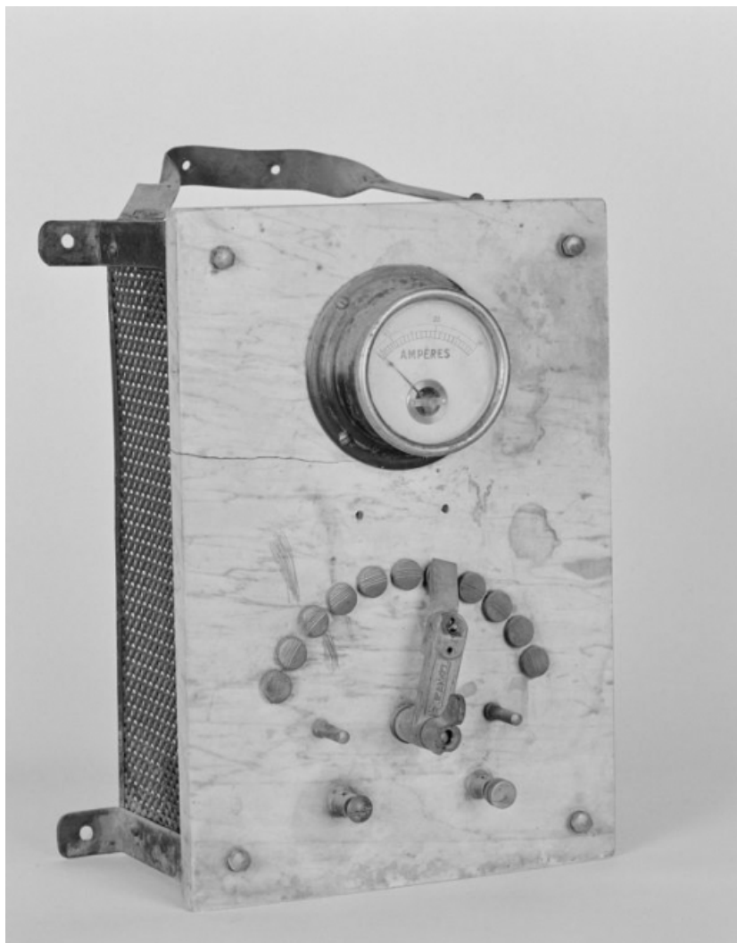
Accessoire d'éclairage, 1988 : rhéostat (transformateur).
