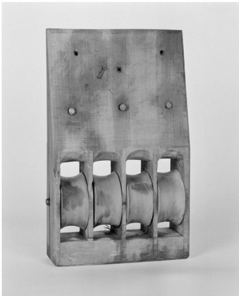
Accessoire des cintres, 1988 : poulie quadruple.
