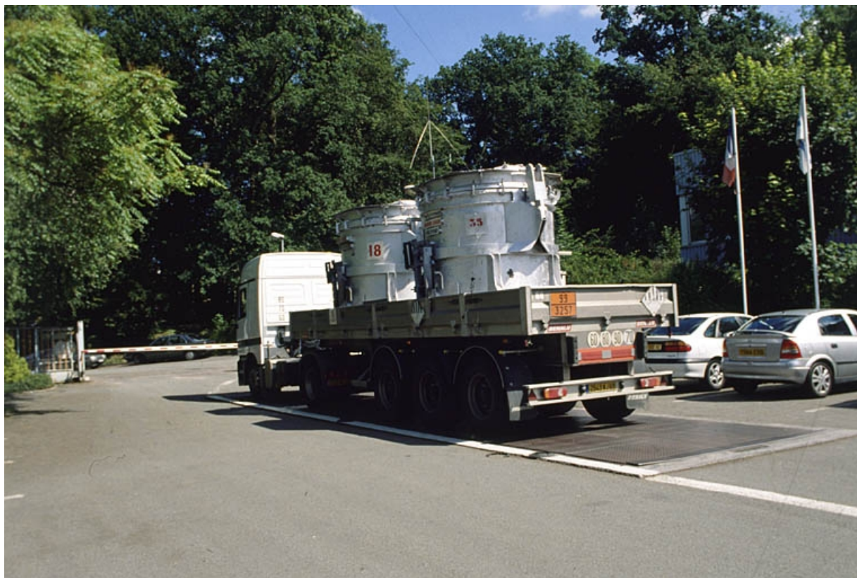
Camion chargé de deux poches d'aluminium liquide.
