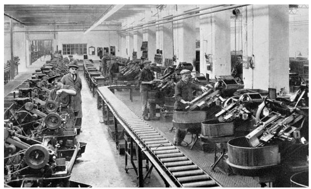
Batterie de machines automatiques à fileter et à fendre les têtes. 90, Delle, 28 faubourg de Belfort
