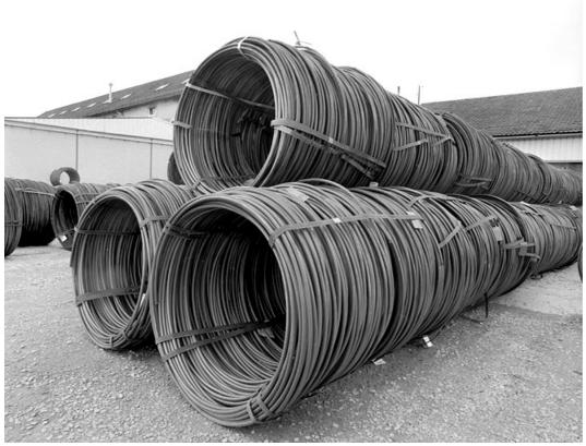
Bobines de fil d'acier destinées à la fabrication de boulonnerie.
