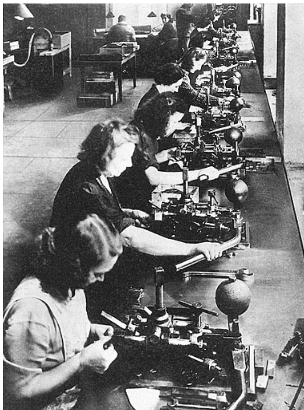
Atelier de fabrication des ardillons.
