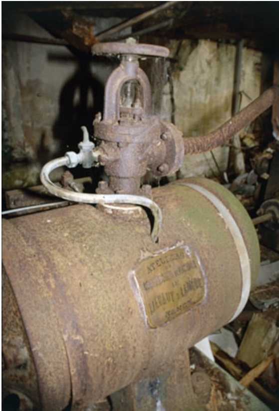
Machine à vapeur : le cylindre.
