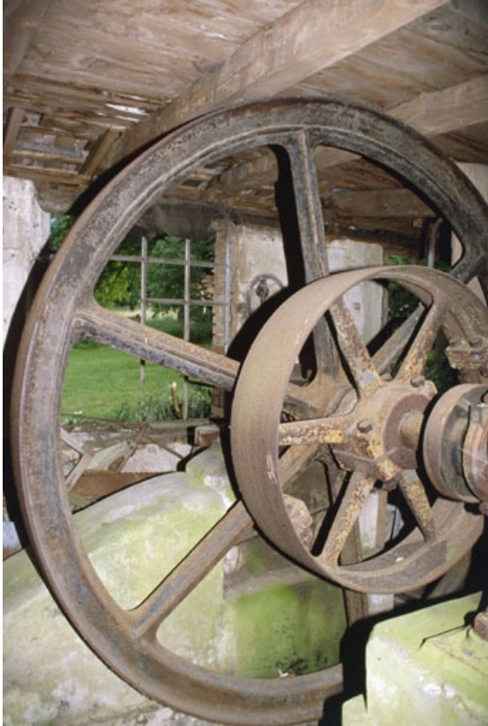
Machine à vapeur : détail du volant de transmission. 90, Suarce R.D. 13
