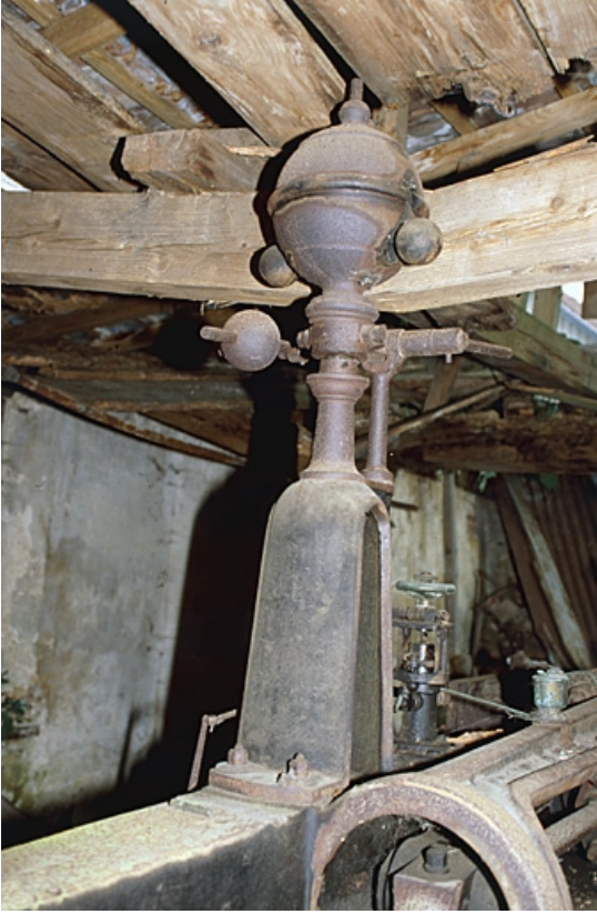
Machine à vapeur : détail du régulateur à boules. L'entrait de la charpente, brisé, repose sur le régulateur. 90, Suarce R.D. 13
