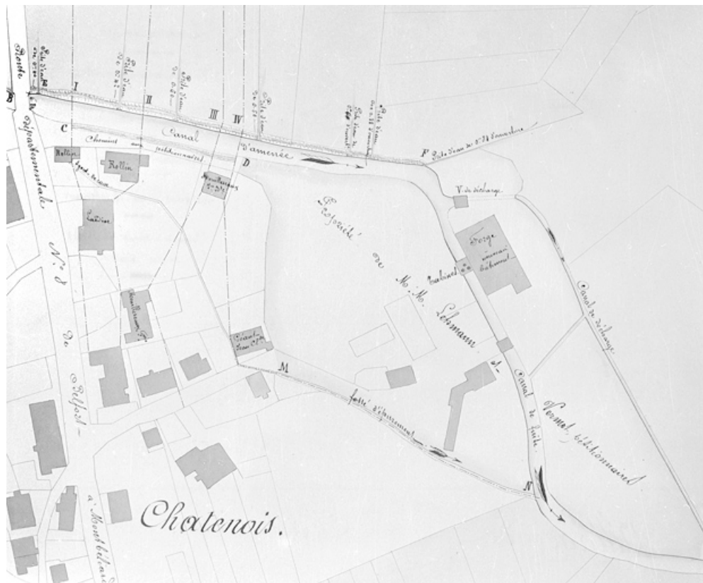
Plan des lieux [...] sur la demande des sieurs Vermot et Lehmann, tendant à réunir les 2 chutes en une seule. 90, Châtenois-les-Forges, 7 avenue des Forges
