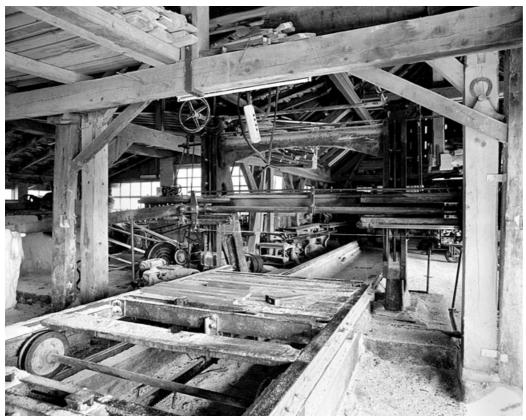
Châssis de scie horizontale monolame.
