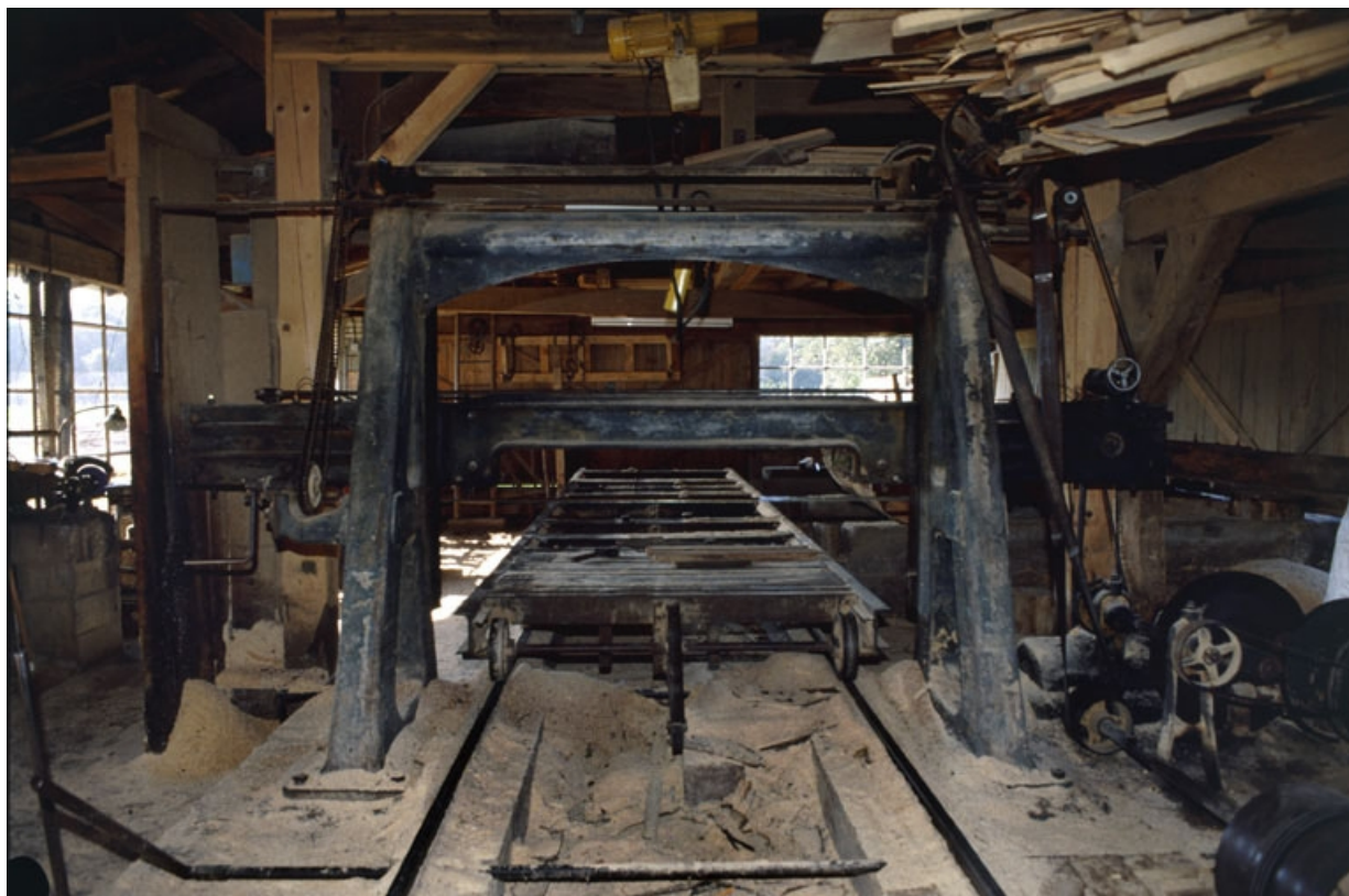
Châssis de scie et son chariot. 90, Bethonvilliers, 2 rue du Moulin
