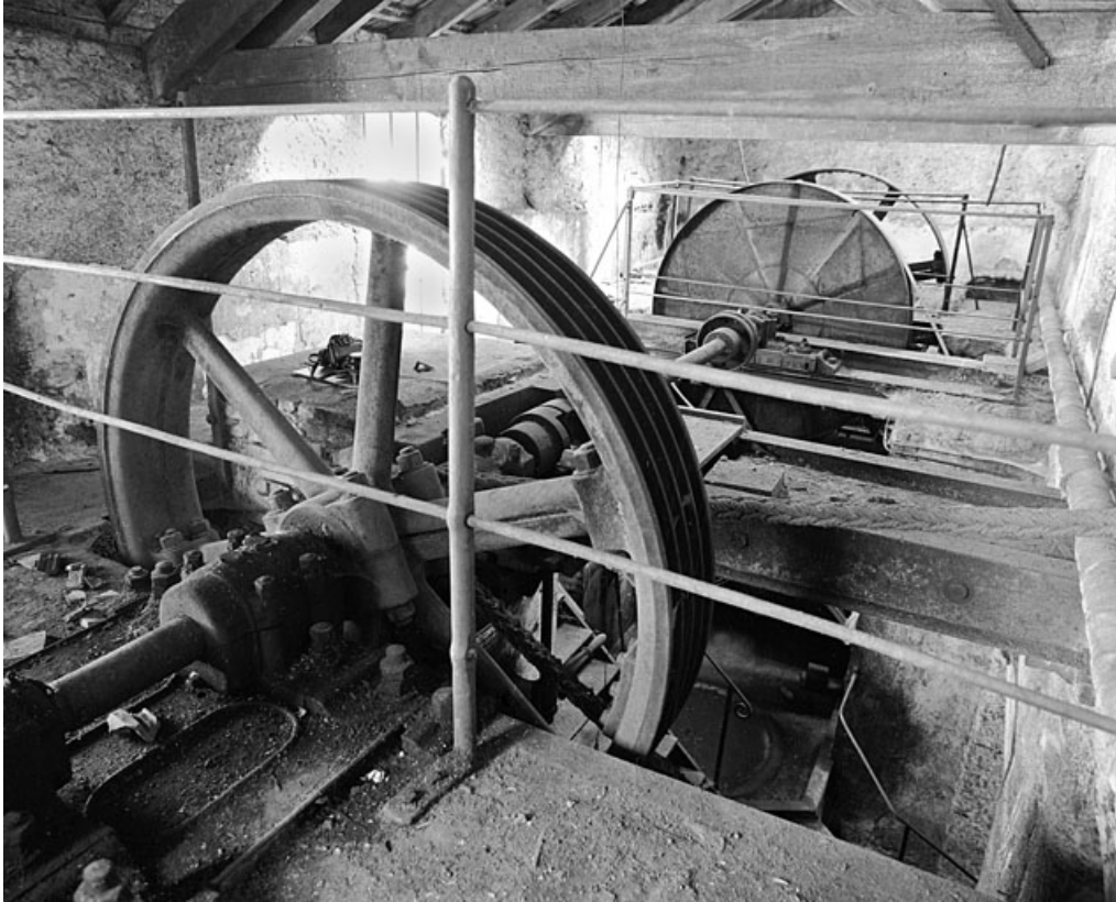
Roue de transmission de la machine à vapeur. Cette roue à 4 gorges est également couplée au volant d'inertie de la turbine (au second plan).
