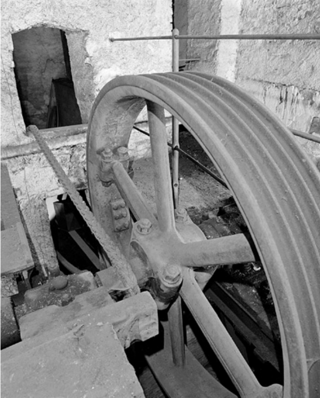
Détail de la roue de transmission de la machine à vapeur. Les gorges de la roue accueilleraient des câbles en chanvre de section carrée (l'un d'eux est visible contre l'axe de la roue).
