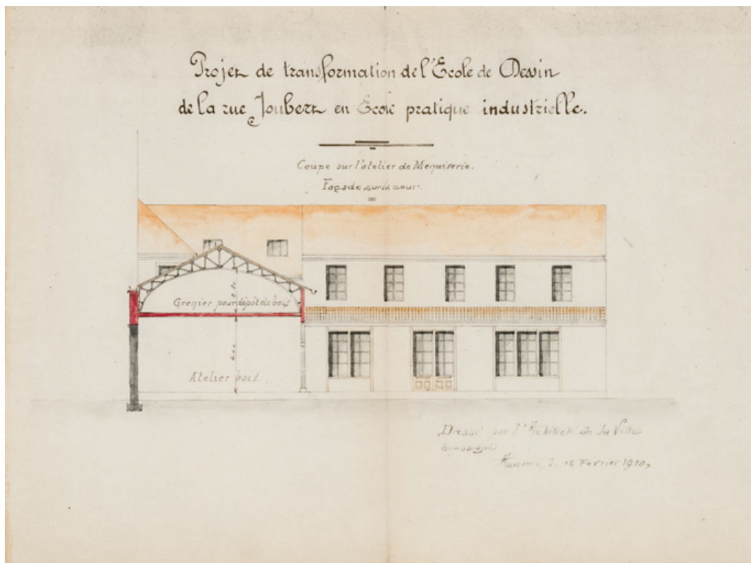
Projet de transformation de l'école de dessin de la rue Joubert en école pratique industrielle. Coupe sur l'atelier de menuiserie. Façade sur la cour. Février 1910.
