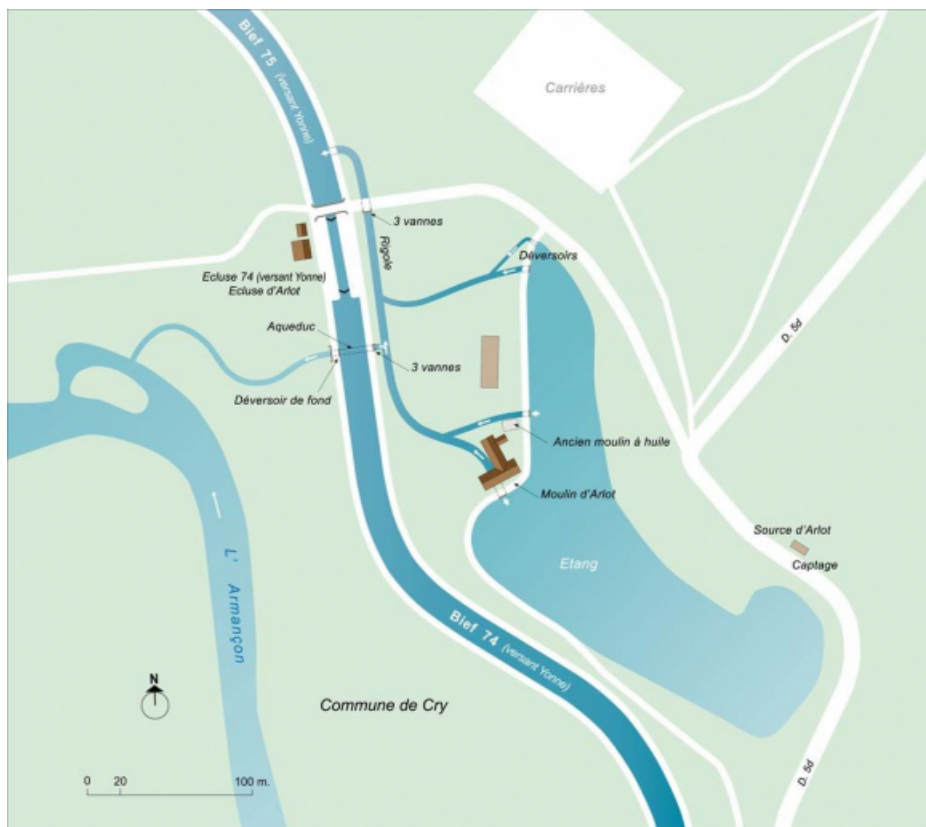
Plan schématique du réseau hydraulique aux biefs 74 et 75 du versant Yonne et du moulin d'Arlot. 89, Cry, lieudit : bief 74 du versant Yonne
