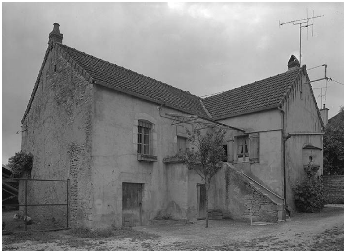
Maison de plan en L avec escalier extérieur en équerre et échauguette (?) sur façade latérale droite du retour.
