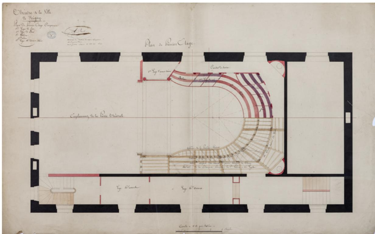
Construction de la salle de spectacle. Plan du 1er étage comprenant 1ères loges de face, 1ères loges de côté, 1ère galerie, balcon, 1ères loges d'avant-scène. 1832.
