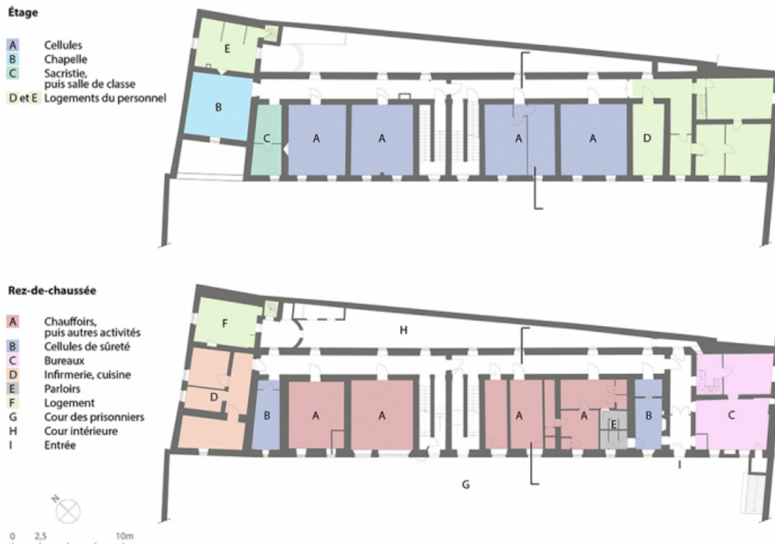
Plans du rez-de-chaussée et de l'étage, échelle 1/250. 2025.
