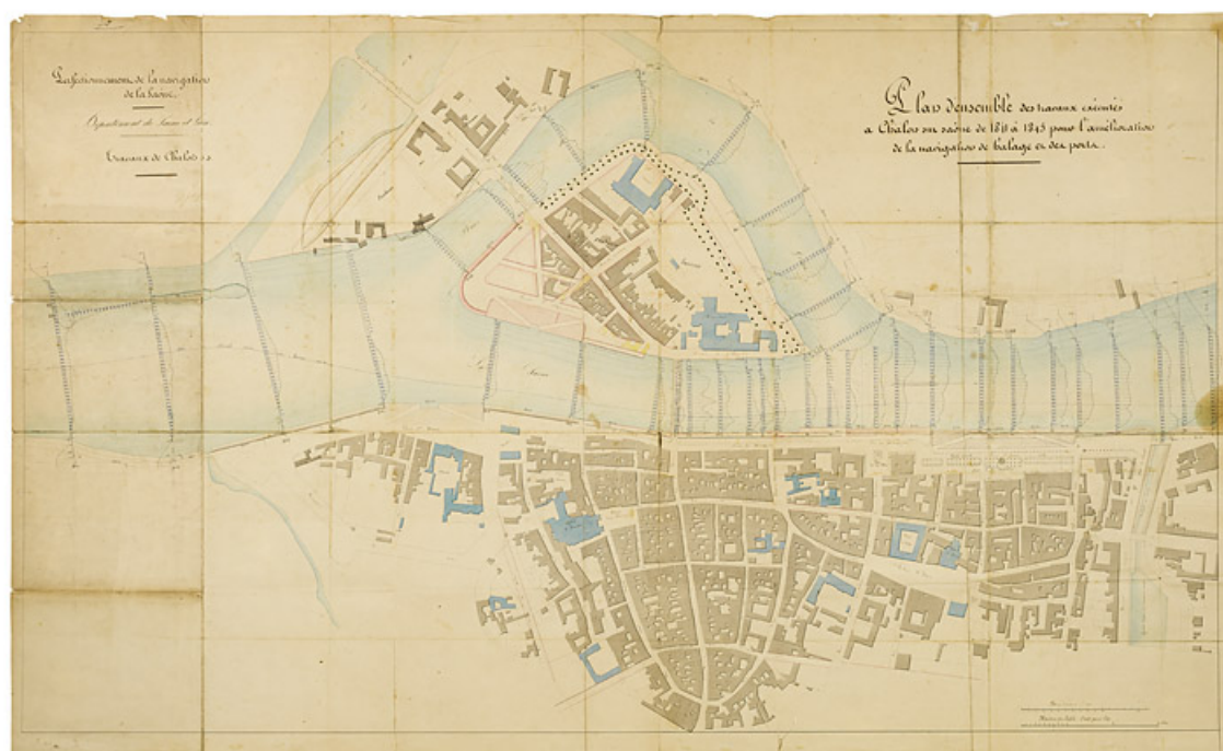
Plan d'ensemble des travaux exécutés à Châlons sur Saône de 1841 à 1845 pour l'amélioration de la navigation de halage et des ports.
