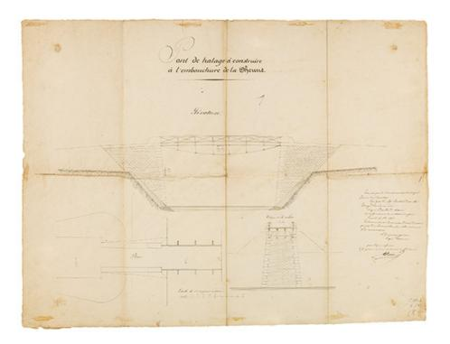
Pont de halage à construire à l'embouchure de la Dheune. Plan, coupe et élévation. Dessin, 30 août 1837.
