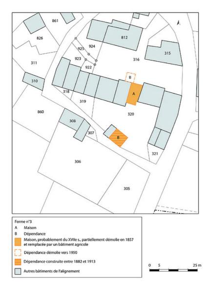
Plan de masse et de sitution de la ferme  $n^{\circ}3$  de l'alignement de Mans, présentant l'évolution des bâtiments. Extrait du plan cadastral, 2020, section A, échelle 1/2500.
