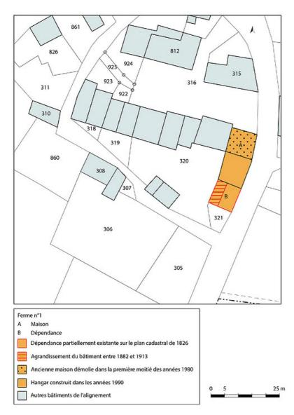
Plan de masse et de situation de la ferme  $n^{\circ}1$  de l'alignement de Mans, présentant l'évolution des bâtiments. Extrait du plan cadastral, 2020, section A, échelle 1/2500
