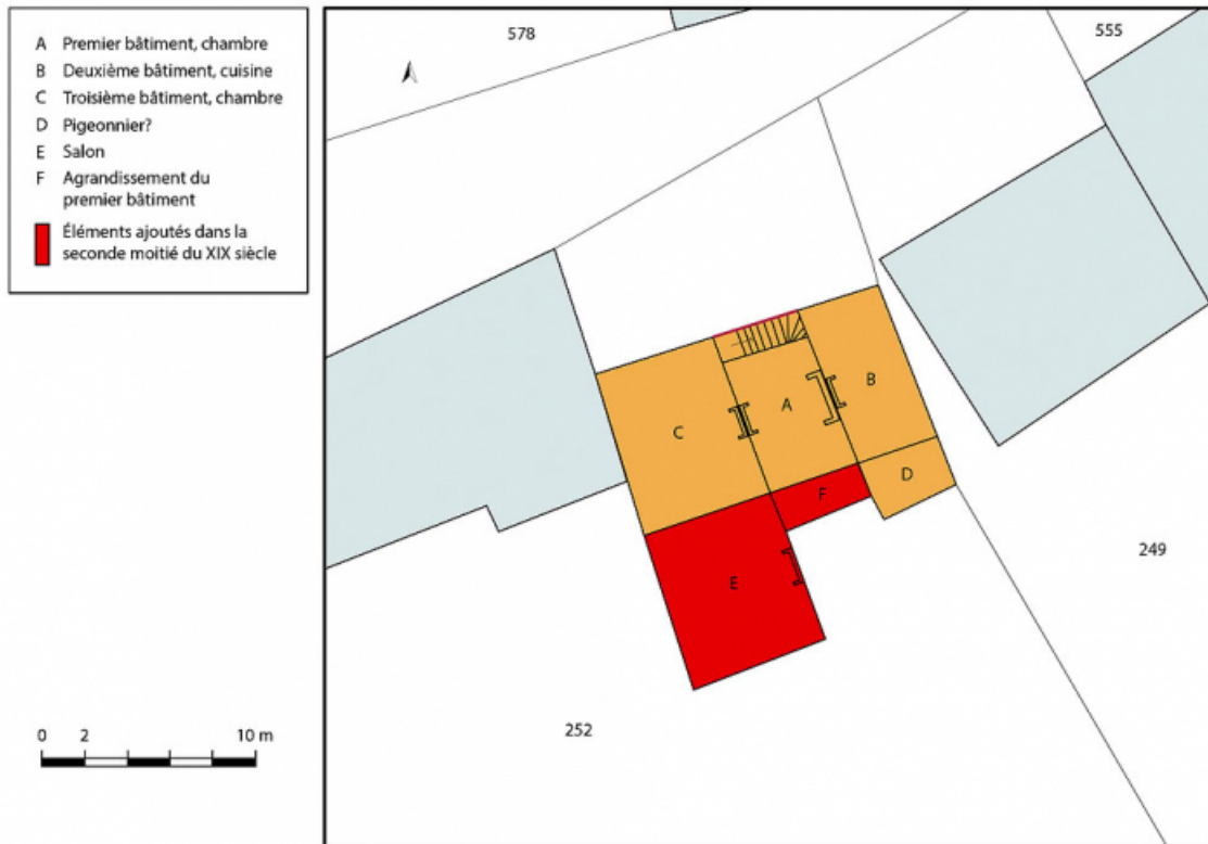
Plan de masse et de situation de la maison, dite "de Claude-Marie Despierres", présentant l'évolution du bâtiment. Extrait du plan cadastral, 2020, section A, échelle 1/1000.
