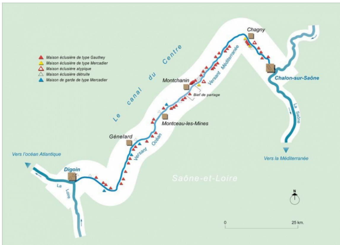
Carte schématique du canal du Centre avec la localisation des différentes maisons éclusières et de garde.
