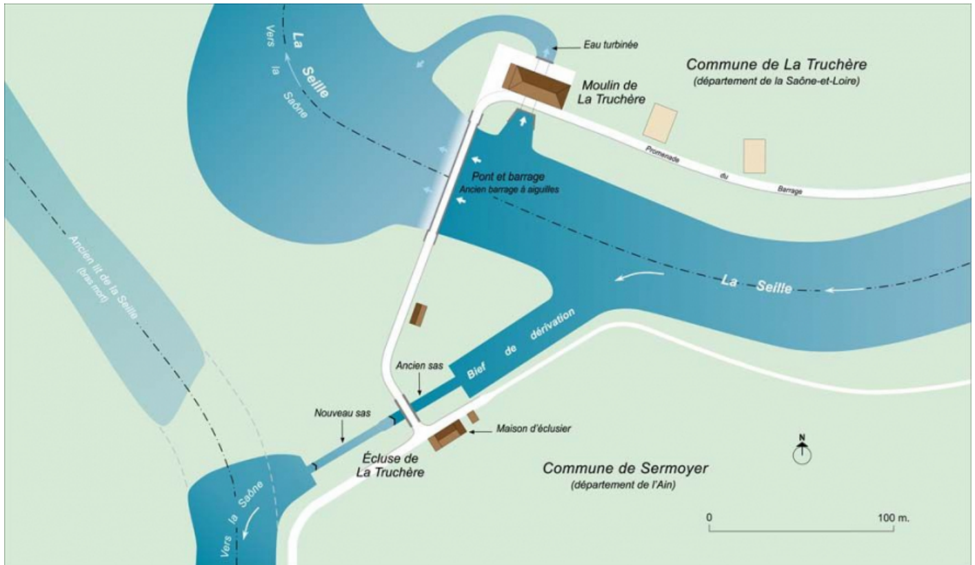
Plan schématique du site de l'écluse de La Truchère, du barrage et du moulin de La Truchère. 71, La Truchère, lieudit : la Tuilerie
