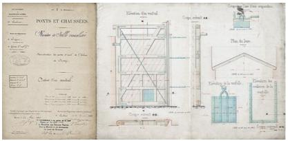
"Construction des portes d'aval de l'écluse de Cuisery : dessin d'un vantail" par Gardie, conducteur principal faisant fonction d'ingénieur ordinaire, le 28 février 1889, visé par Jozon, ingénieur en chef. (Archives VNF-direction territoriale Centre-Bourgogne ; subdivision de Montceau-les-Mines)
