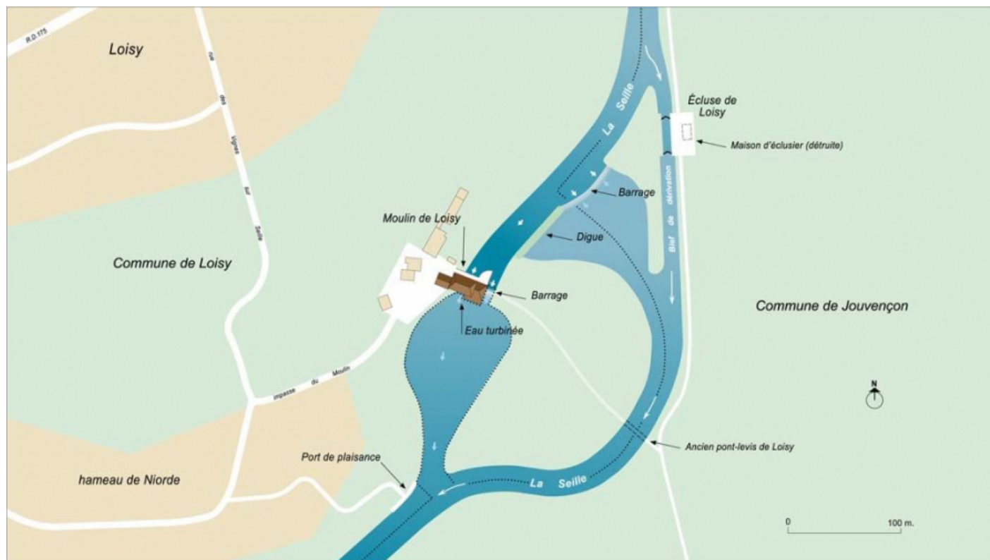
Plan schématique du site de l'écluse de Loisy, des barrages, du pont et du moulin de Loisy.
