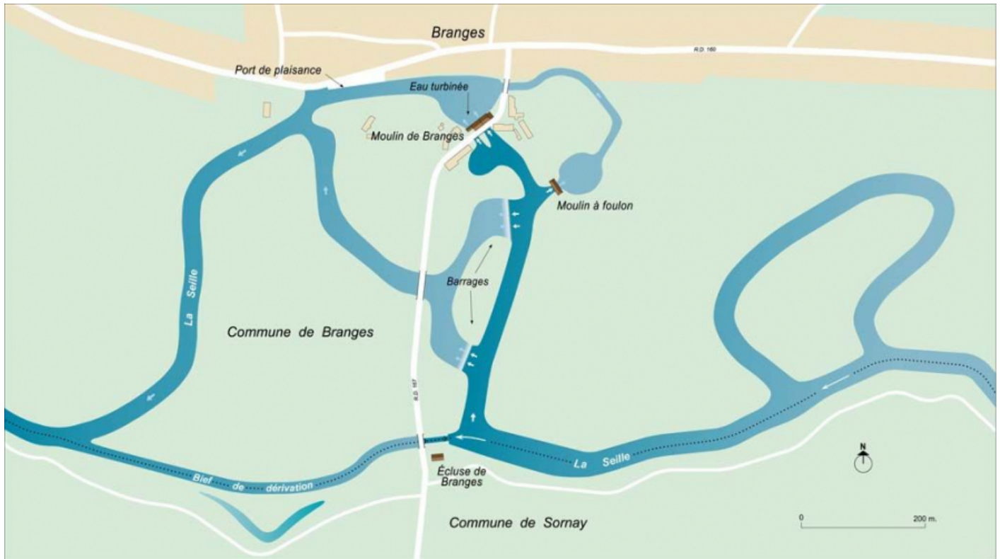
Plan schématique du site de l'écluse de Branges, des barrages et des moulins.
