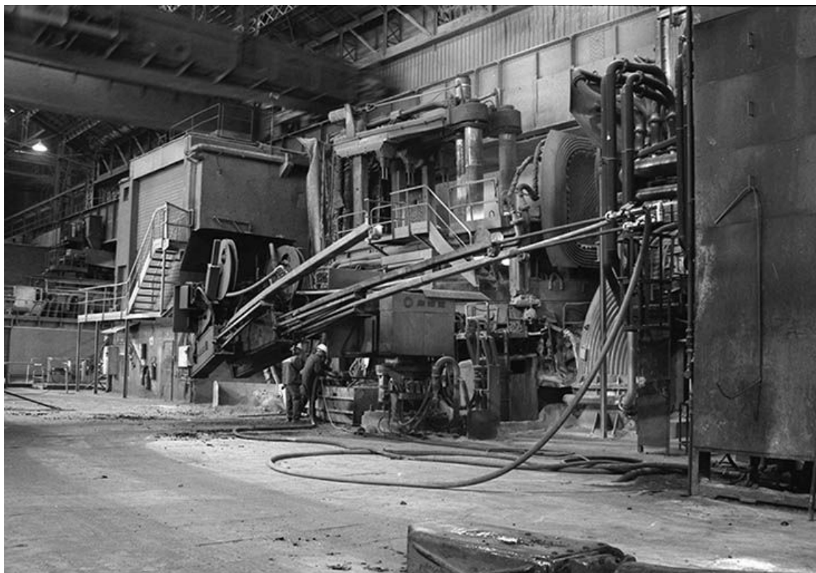
Le four électrique de 100 tonnes en activité.
