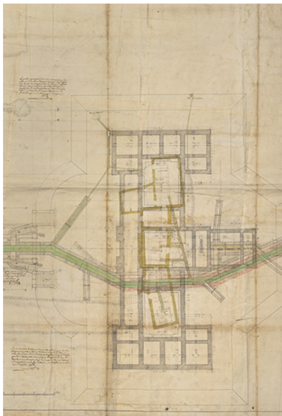
Plan d'ensemble pour la reconstruction de l'établissement thermal, avec l'emplacement des anciens bains (vers 1761), détail du bâtiment nord dit du Grand Bain.
