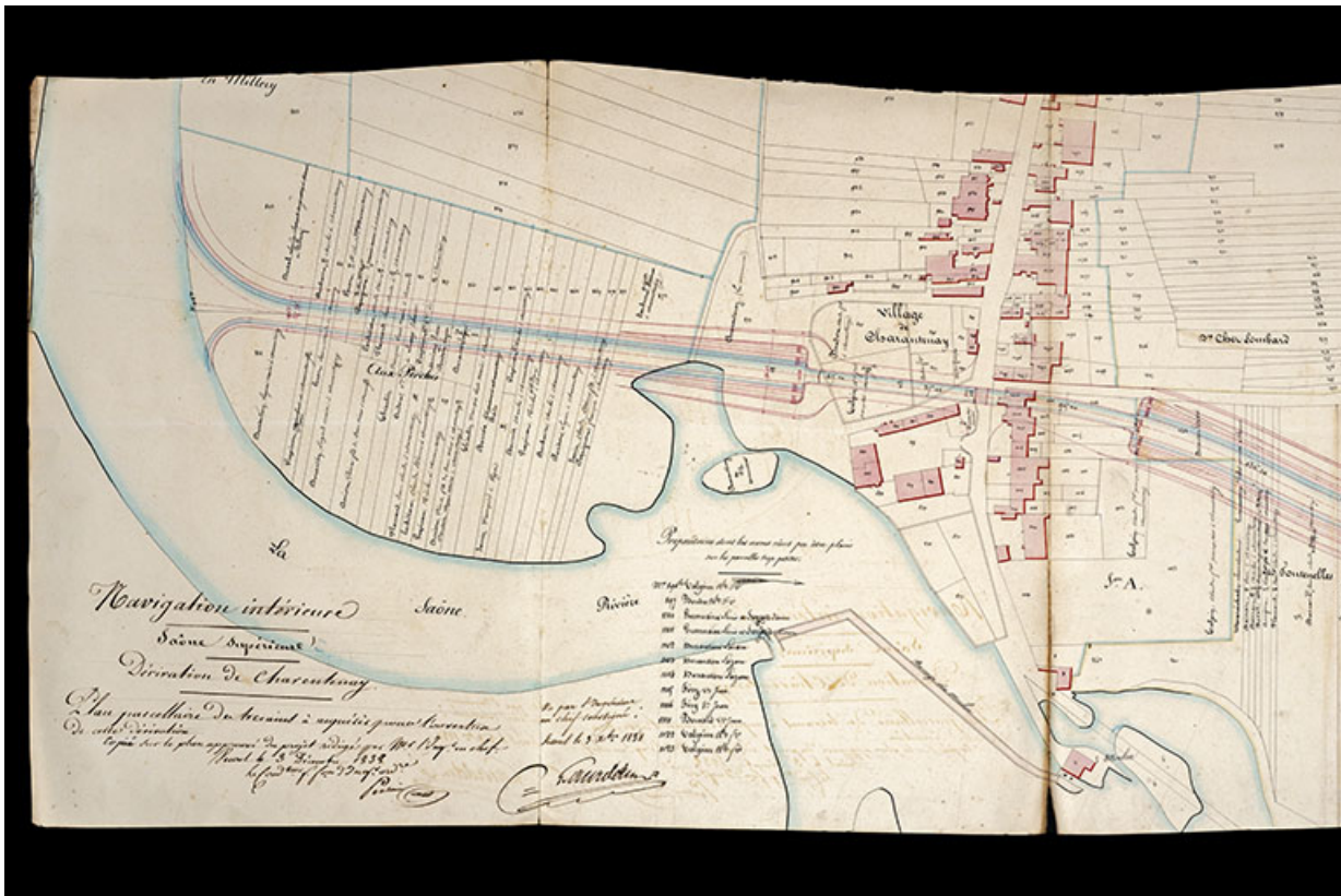
Détail de la dérivation au niveau de la future porte de garde et du pont tournant, 1838. 70, Soing-Cubry-Charentenay
