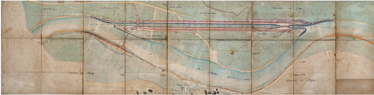
Bief de Rigny. Construction d'une dérivation éclusée, d'un barrage mobile et d'un chemin de halage. Plan général (1876). 70, Rigny
