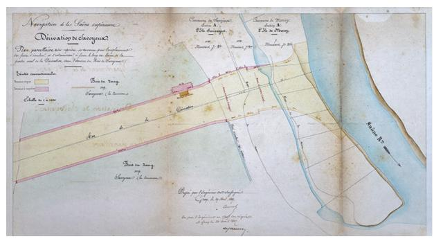
Plan parcellaire des reprises de terrain pour I emplacement des fossés d'écoulement et d'assainissement à faire le long des levées de la partie aval de la dérivation, dans l'étendue du bois de Savoyeux, 1847.
