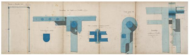
Construction du barrage mobile et de la seconde porte de garde de St-Albin - Fermettes et aiguilles (1876). 70, Scey-sur-Saône-et-Saint-Albin
