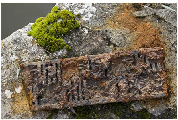
Morceau d'une échelle limnimétrique.
