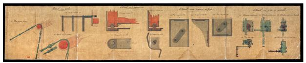
Construction du barrage mobile et de la seconde porte de garde de St-Albin - Détail des fourures de la porte de garde (1874). 70, Rupt-sur-Saône
