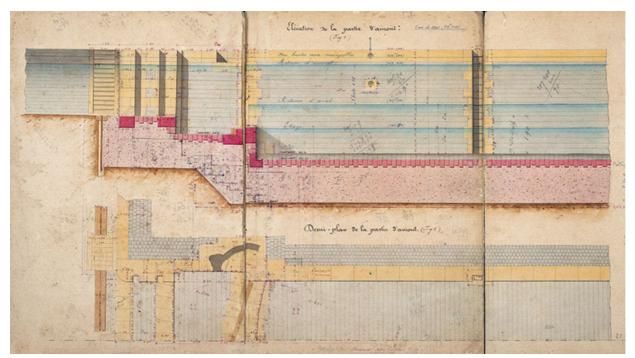
Construction de la dérivation de Port-sur-Saône - Ecluse à sas (1876) : élévation de la partie amont. 70, Port-sur-Saône chemin communal du Pré de la Maladière
