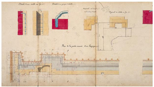
Construction de la dérivation de Port-sur-Saône - Ecluse à sas (1876) : détail d'une chelle en fer, détail d'une poignée d'echelle et plan de la partie amont d'un bajoyer.
