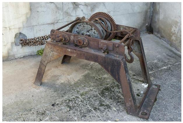
Le treuil qui permettait d'actionner les portes de garde.
