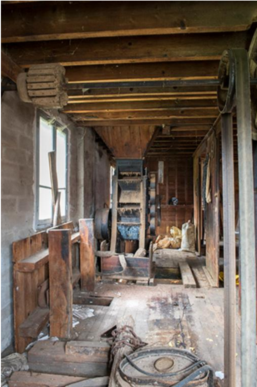
Vue du système de poulie et courroie et de trémie et broyeur à grains, au premier étage 70, Chemilly Grande rue
