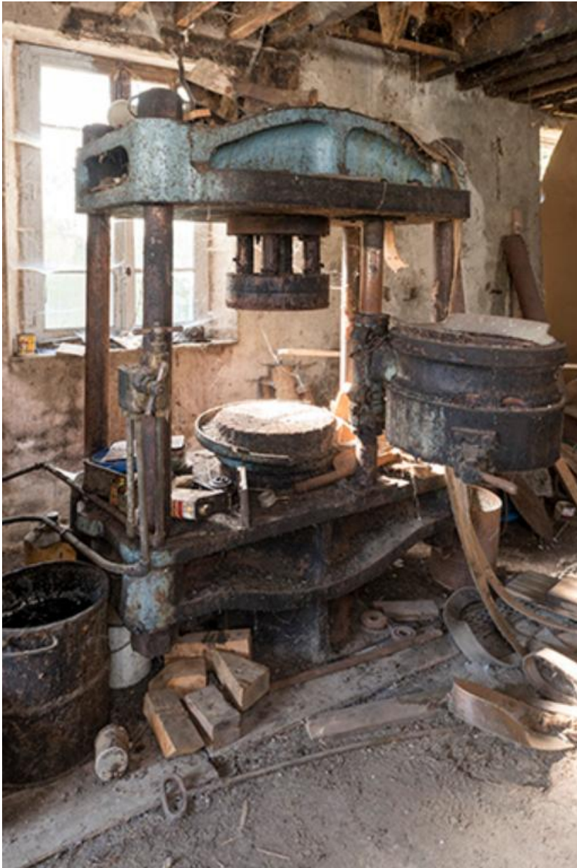
machine du rez-de-chaussée: presse hydraulique
