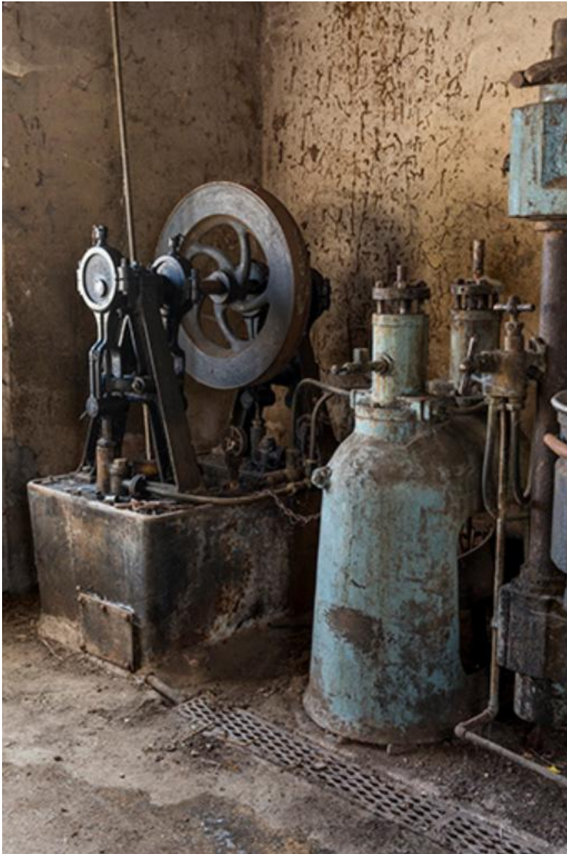
Machines du rez-de-chaussée: pompe hydraulique et régulateur
