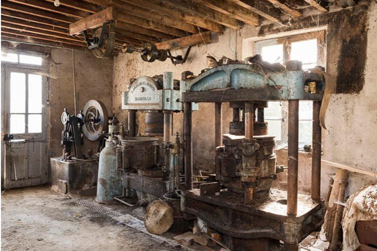
Vue des machines du rez-de-chaussée: pompe hydraulique, régulateur et deux presses hydrauliques 70, Chemilly Grande rue
