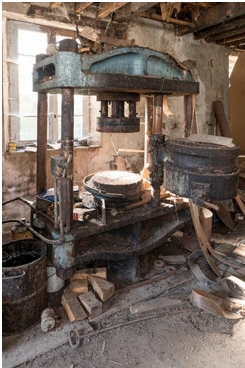
machine du rez-de-chaussée: presse hydraulique
