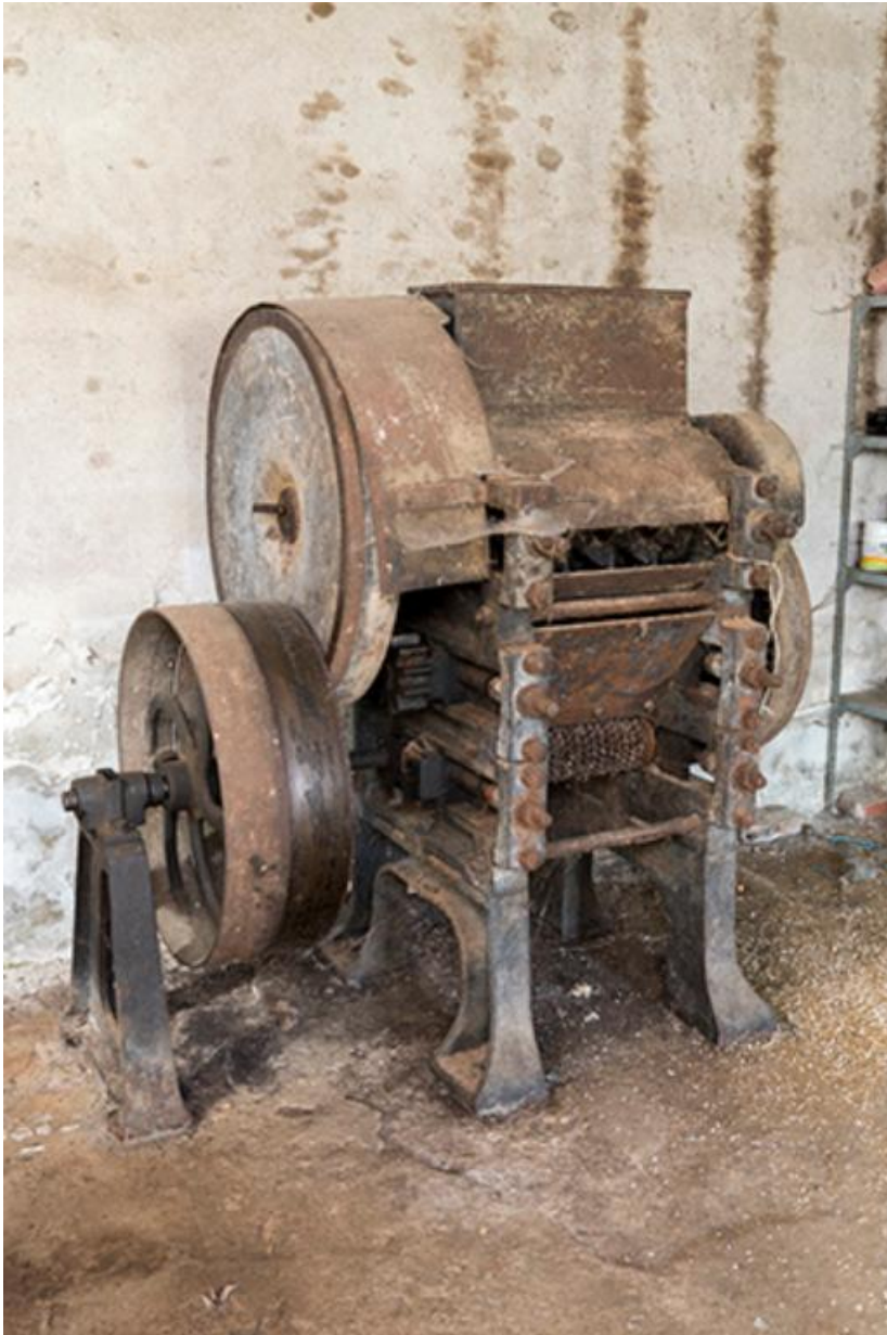
Machine du rez-de-chaussée: broyeur à tourteaux
